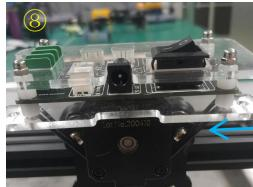
⑧. Wie in der Abbildung gezeigt: Adapterplatte am Motor mit zwei Kabelbindern befestigen
