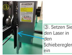
③. Setzen Sie den Laser in den Schieberegler ein
