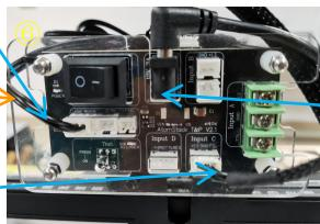
⑥.2 Hilfstromversorgung: Es wird empfohlen, das Netzteil unter 12 V3A an das Hilfssystem anzuschließen, und das Hilfssystem ist für 12 V 3A (im Lieferumfang enthalten) und mehr nicht erforderlich. Dies kann natürlich je nach Modell variieren. Solange die Laserleistung die maximale Ausgangsleistung erreichen kann, ist keine externe Hilfstromversorgung erforderlich.
