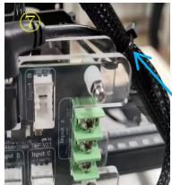
⑦. Verbinden Sie die Ausgangsleitung des 3PIN-Signals mit einem Kabelanschluss
