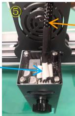
⑥.1. Schließen Sie den 3PIN-Signalausgang an
