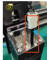
⑨. Bei Verwendung der Adapterplatine in dem von uns hergestellten Gravierer kann diese ohne die Adapterplatine angeschlossen werden, und die Modulkomponenten können direkt mit der in der Abbildung gezeigten Anschlussleitung verbunden werden.
